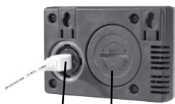
Raccordement mini USB (Paramètres et téléchargement des données) Compartiment des piles (BAT.)
